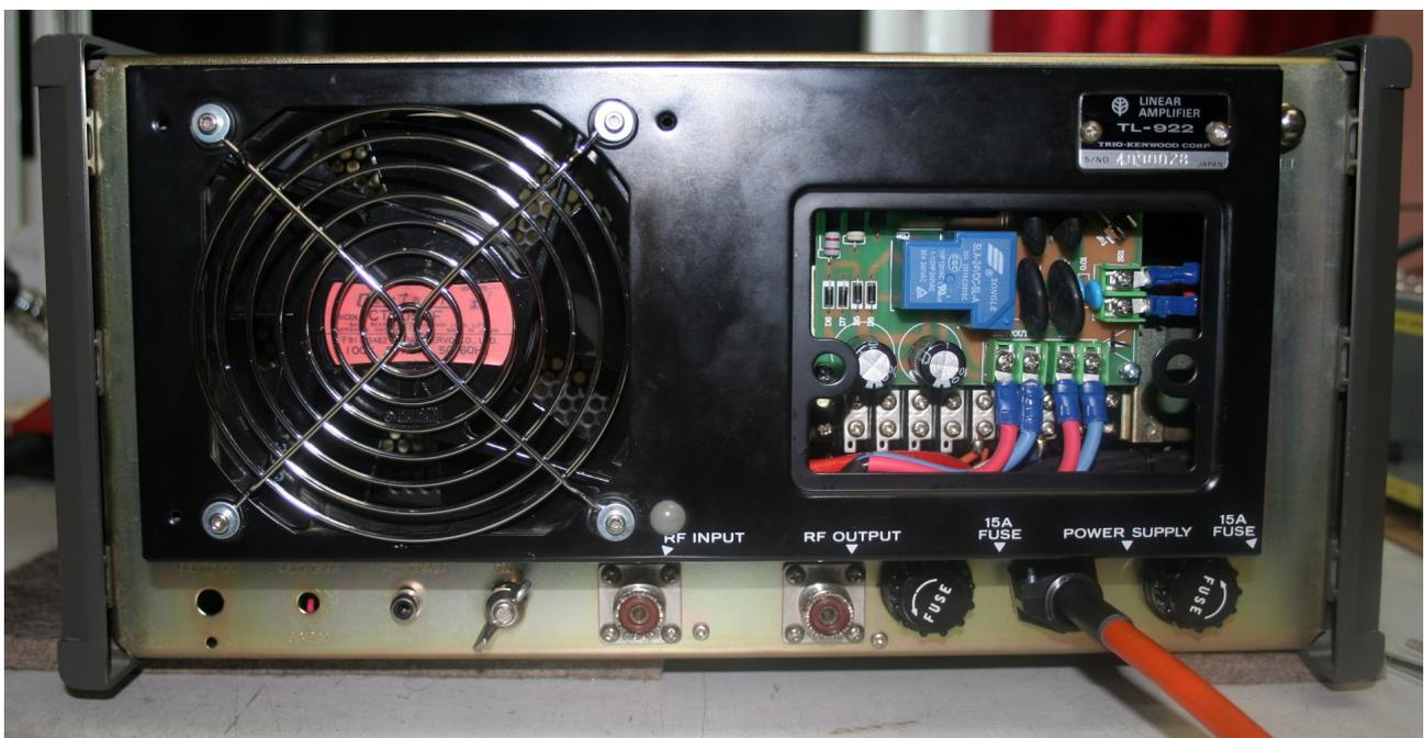
Bei der HF-Seitigen Rx-Tx Umschaltung wurde das laute original Relais durch zwei Vakuumrelais ersetzt.
